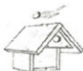
Auch für den Giebelkasten sollten Sie 20 mm starkes, astfreies Massivholz nehmen. Ebenfalls sollten nur verzinkte Stahlschrauben oder Edelstahlschrauben Verwendung finden. Wenn Sie auf das Da ein Stück Dachbahn mit sog. Dachpeppnägeln anheften, so ist das sicherlich nicht verkehrt.
